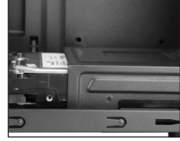
3- Sürücüyü yukarıdaki resimde gösterildiği gibi vidayla kasa gövdesine sabitleyin
