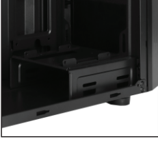
1- 3,5 inç depolama ekipmanı kurulum bölümüne
