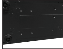
3-Daha sonra sürücü kasasını alttan kasa gövdesine vidalayın
